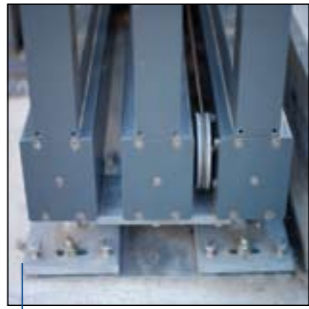
Umlenkrolle Teleskop-Tor im Detail
