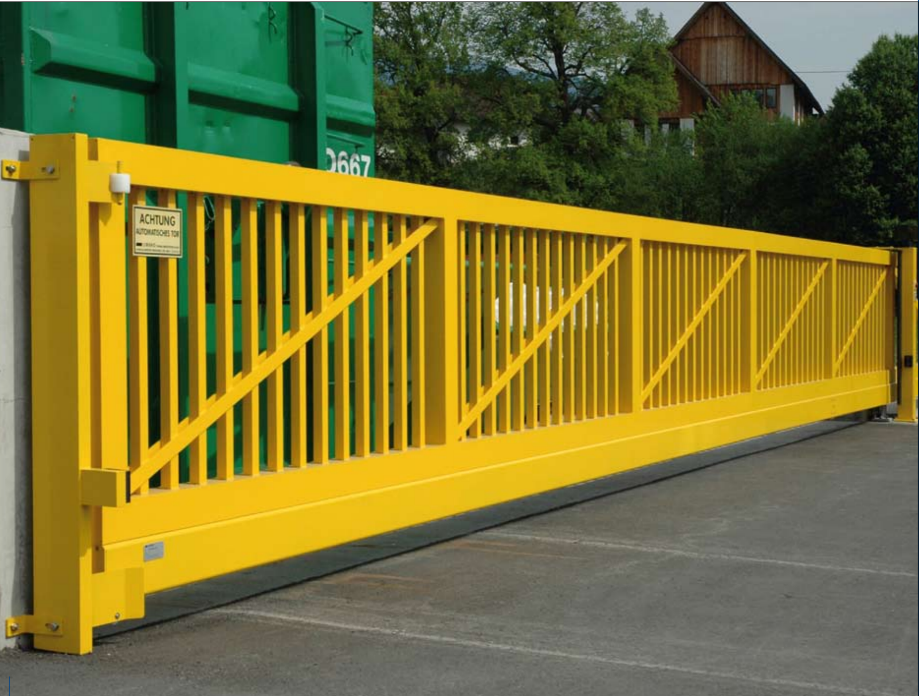
Schiebetor Typ ST, Säulenlichte 11 m, mit seitlicher Einlaufschiene und Einlauf- schuh. Mit Zugbändern in den Torfeldern.
