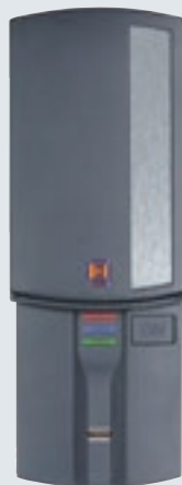
Funk-Fingerleser FFL 12 BS // NEU 2 Funktionscodes und bis zu 12 Fingerabdrücke
