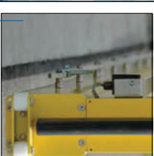
Rückwärtige Entlastungsrolle mit Schutzblech
