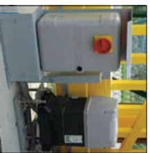
Antrieb mit verstellbarer Motorconsole mit Schaltschrank und Hauptschalter
